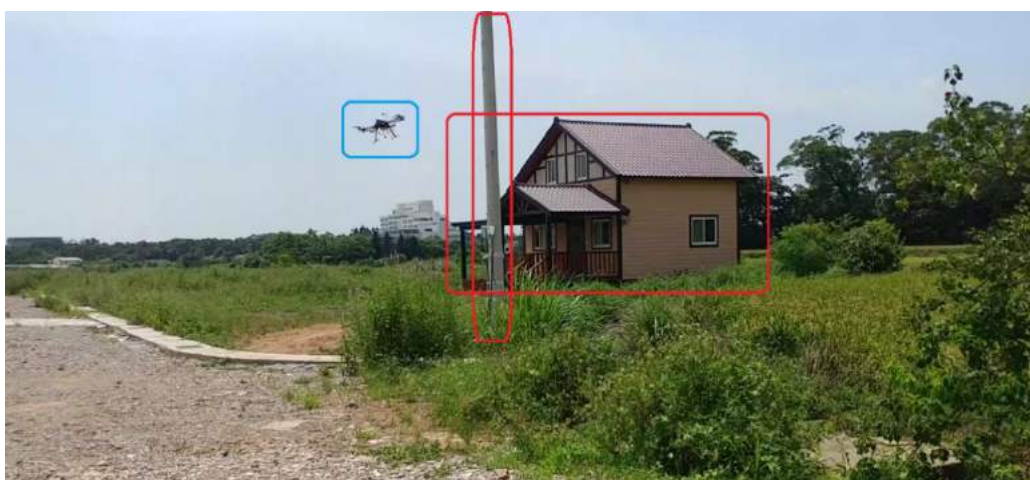
圖 5.8. 飛行器避開電線桿後往左側避障。
