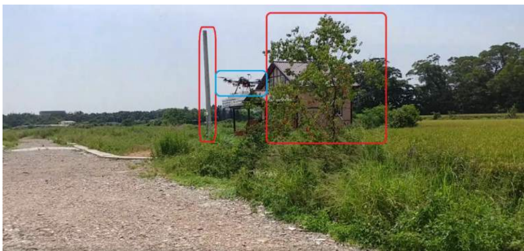
圖 5.7. 飛行器避開樹障礙物後往左側避障。
