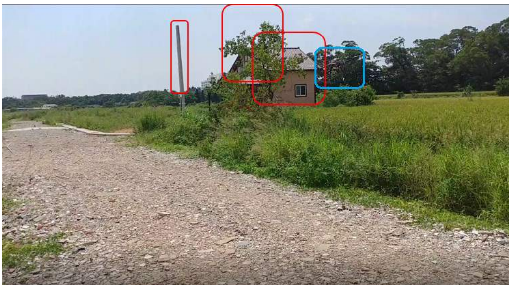
圖 5.6. 飛行器偵測到障礙物環境時避障反應前。
