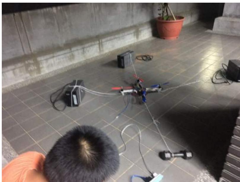
圖 5.11. 飛行器起飛前綁上重物的實驗環境。
